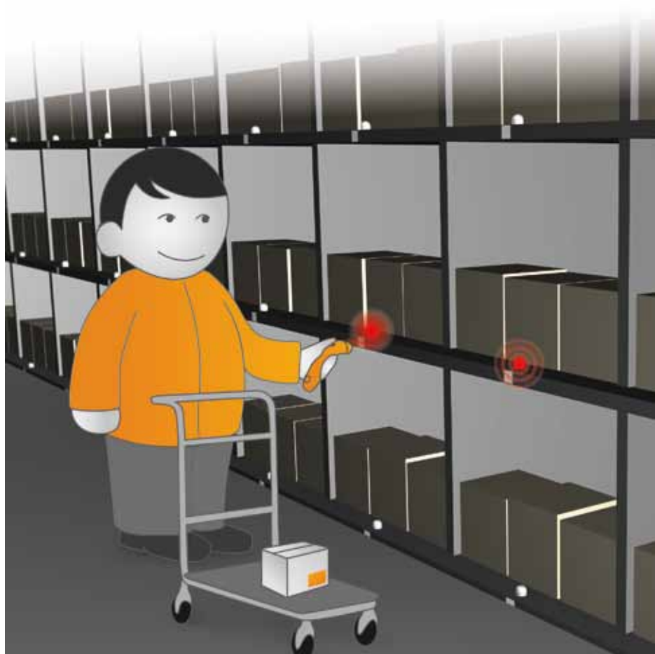
Beleglose Kommissionierung mit SCAN-2-LIGHT: Die Signalleuchten an den Lagerplätzen zeigen an, wo der nächste Artikel zu entnehmen ist.
